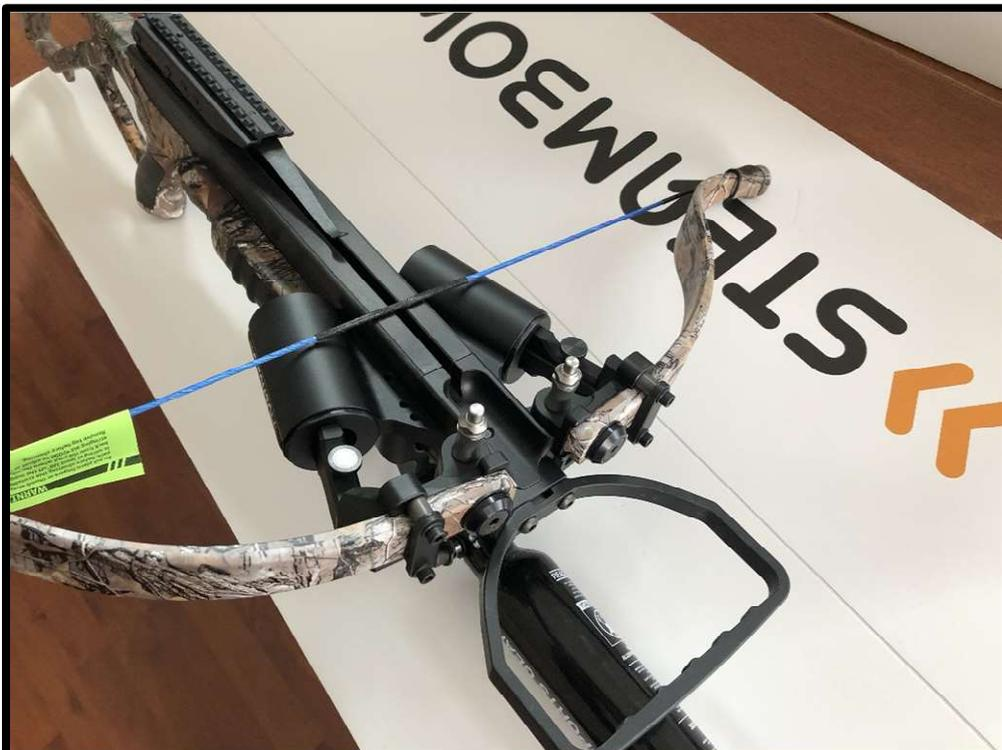
Abbildung: Die Arretierungsblöcke sind montiert. Die Rändelschraube kann, je nach Wunsch, sowohl nach oben wie nach unten zeigen.
