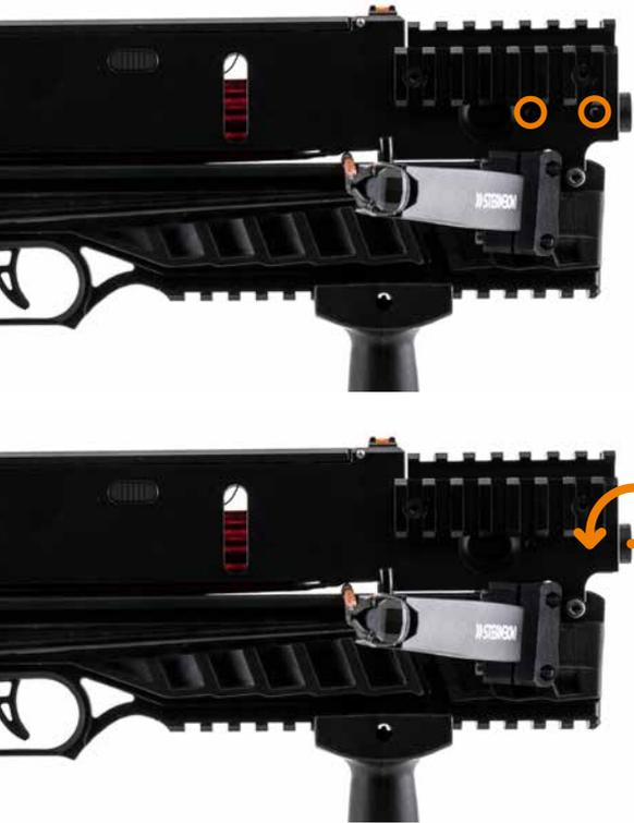
Lösen bzw. lockern Sie die zwei kleinen Madenschraube an der Seite des Magazins. Der Laser lässt sich dann drehen bzw. bewegen.
